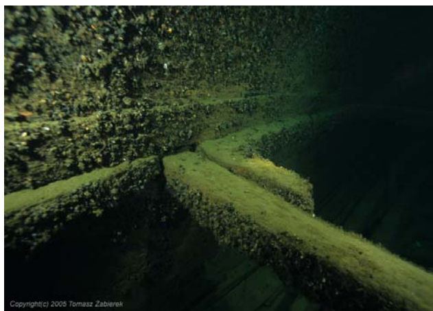
Fot. 5. - Mocowanie jednego z pokładników dolnego pokładu do burty
